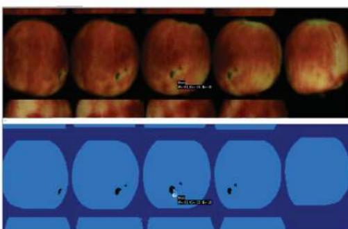
شرکت مهندسی علم و فن آراد برای اولین بار در کشور اقدام به ساخت ماشین سورتینگ میوه با تکنولوژی بینالی و پردازش تصویر نموده است. این ماشین با قابلیت جابجایی آسان و امکان استقرار در هر جا و حتی در باغ و بدون نیاز به هوای فشرده قابلیت جداسازی و سورت انواع میوه بر اساس شاخصهای مختلف را دارد. خروجی ماشین میز تقسیم یا پالت های میوه و در چهار گروه بندی مختلف و یا بیشتر می تواند باشد.
