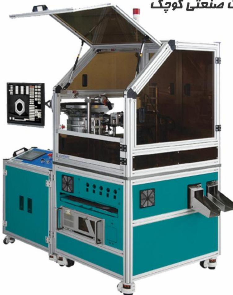
شرکت مهندسی علم و فن آراد برای اولین بار در کشور اقدام به ساخت ماشین سورتینگ پیچ، مهره و قطعات صنعتی با تکنولوژی بینایی و پردازش تصویر نموده است. این ماشین می‌تواند برای مددوچه مشخصی از پیچ‌ها، مهره‌ها، واشرها، خارها یا سایر قطعات ساخت و تنظیم شود.
